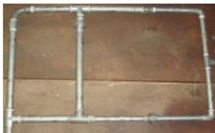
**Gambar 5** Perakitan Instalasi Pipa Tertutup
