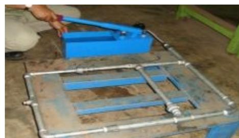
**Gambar 6** Pengujiann Kebocoran
