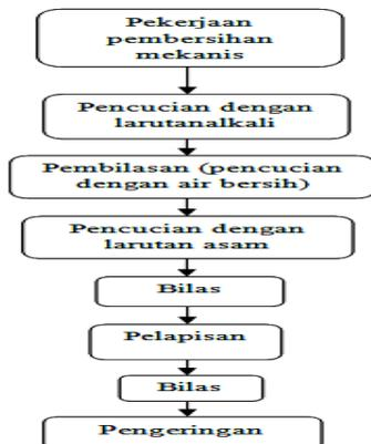
Gambar 2.2 Tahapan pekerjaan
