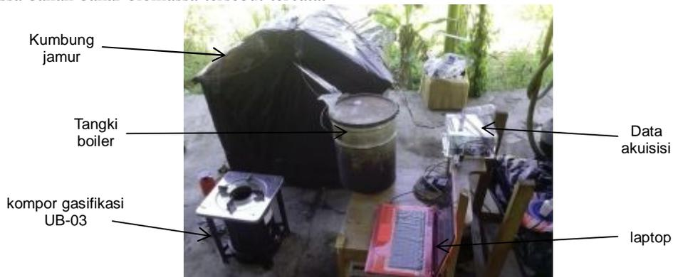
Gambar 2.2 Skema pengujian kompor gasifikasi pada sterilisasi prototipe kumbung
