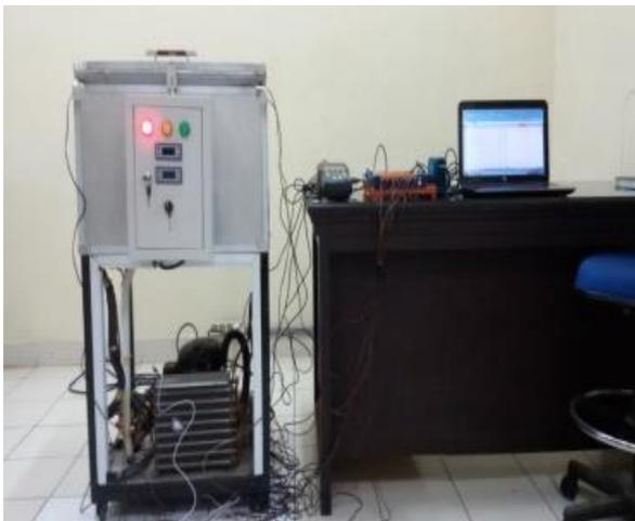
Gambar 2. Rancangan mesin VCO berdasarkan prinsip pompa kalor
