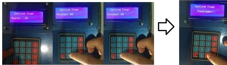
Gambar 6. Input data melebihi aturan sistem pewaktu.
