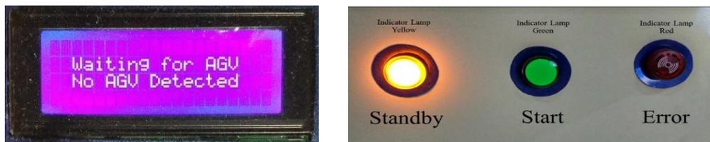
Gambar 7. Tampilan LCD dan indikator pada mode “*standby*”.
