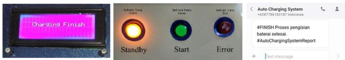
Gambar 9. Tampilan mode “*finish*” pada LCD, lampu indikator, dan SMS.
