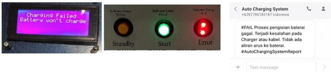
Gambar 10. Tampilan mode “fail” pada LCD, lampu indikator, dan SMS.
