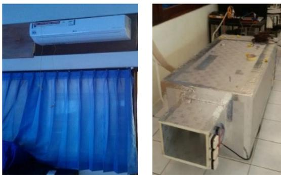
Gambar 3. *Outdoor-indoor* sistem AC *split* domestik untuk pengujian
