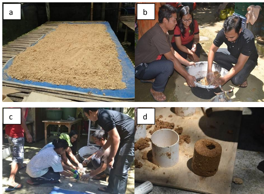
Gambar 5. Pelatihan dan pendampingan pembuatan biobriket: (a) limbah baglog yang telah dikeringkan (b) Tim PKM mengajarkan cara pembuatan adonan biobriket (c) Tim melatih mencetak biobriket (d) biobriket yang dihasilkan
