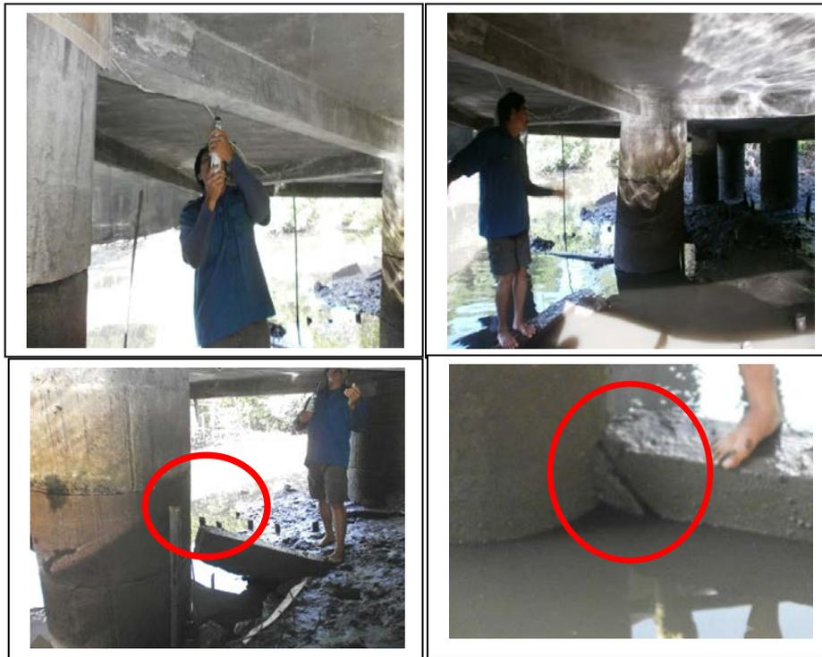
Gambar 6. Pengujian Hammer Test pada Pelinggih Patok
