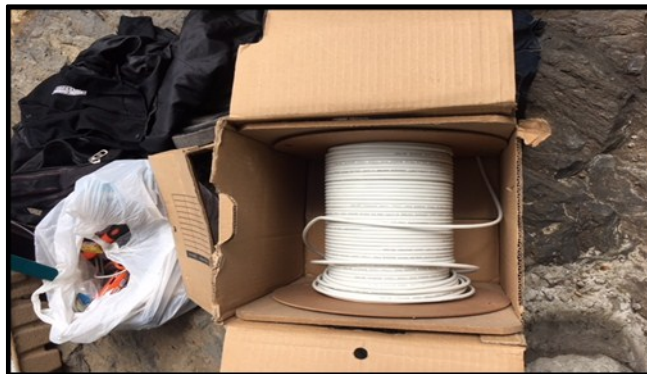
Gambar 4. Kabel LAN UTP CAT 5
