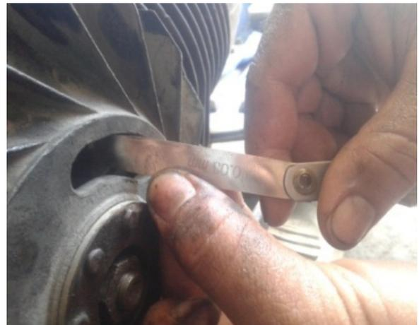
**Gambar 1.** Pengukuran platina
