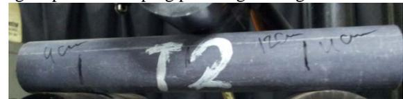
Gambar 19a. Kondisi pipa saat beban awal uji lentur pipa tanpa merek  $\phi$  1"
