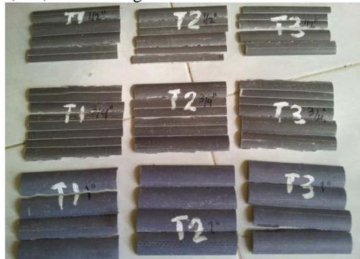
Gambar 12. Kondisi pipatanpa merek sesudah uji lentur  $\phi$  1/2", 3/4", dan 1"
