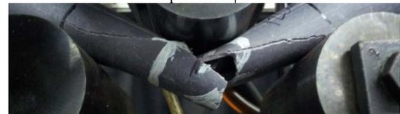
Gambar 19b. Kondisi pipa saat beban akhir uji lentur tanpa merek  $\phi$  1"
