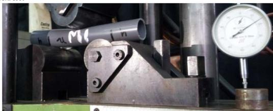
Gambar 18a. Kondisi pipa saat pembebanan awal uji lentur merek M  $\phi$  1/2"
