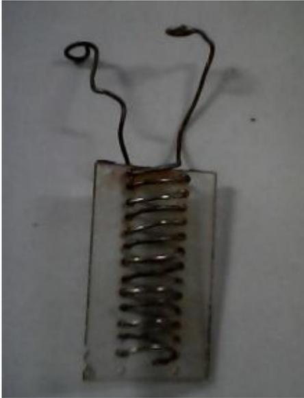
Gambar 1. Elektroda Spiral
