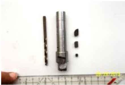
Gambar 3.2 Komponen Pahat Bor Multidiameter
