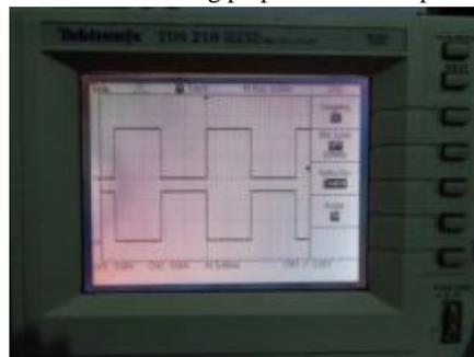
Gambar 10 : Bentuk Gelombang pd pin 10& 11 dengan beban 60W.
