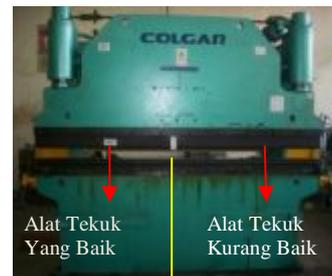
Gambar 1 Mesin Tekuk Pelat
