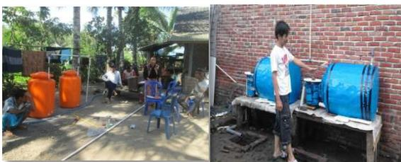
Gambar 3. Hasil rancangan biodigester skala rumah tangga untuk proses konversi energi biomassa
