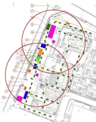
Gambar 3. Zona Bahaya Area Proyek
