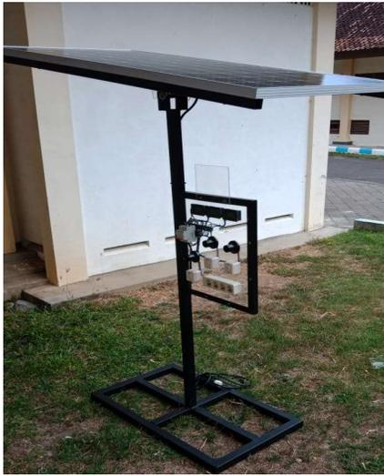
Gambar 6. Model PLTS dengan *micro inverter*.
