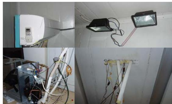
Gambar 1. Instalasi alat uji AC split 1 Pk dan ruang terkondisikan.
