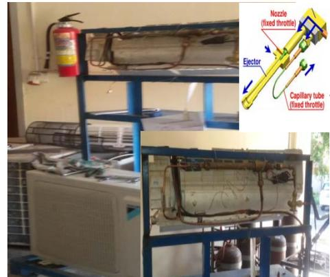
Gambar 3. Instalasi alat uji AC split 1 Pk dengan sistem efektor dua temperatur evaporator
