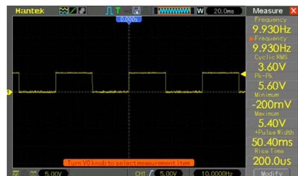
Gambar 2. Gelombang Output Dari Pin 13 Setelah Program di Upload.
