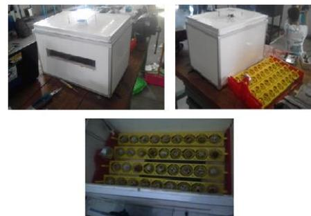
Gambar 2. (a). Rancangan kabin inkubator penetas telur (b). Kabin inkubator penetas telur
