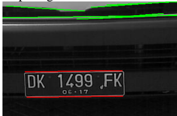
Gambar 8 Kandidat garis hasil tahap thresholding
