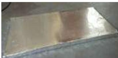
**Gambar 3.** Paket PCM yang siap diintegrasikan ke dalam chest freezer.
