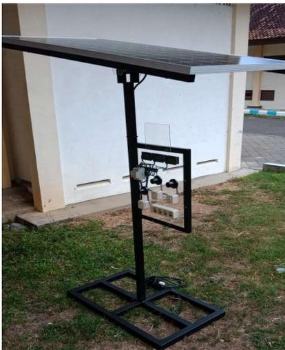
Gambar 6. Model PLTS dengan *micro inverter*.
