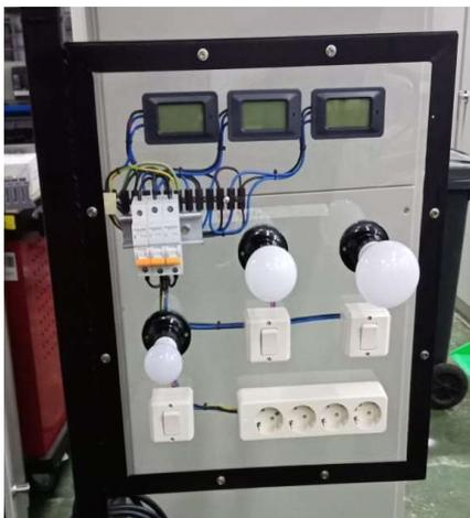
Gambar 7. Panel pada model PLTS dengan *micro inverter*.
