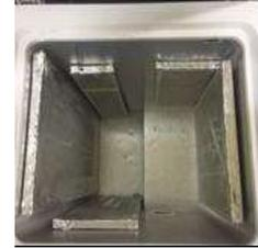
PCM di sisi dalam evaporator
